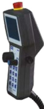
Il Terminale Palmare RM950 è un sistema di controllo remoto, touch screen portatile, per macchine automatiche e centri di lavoro. Consente all'operatore di eseguire diverse operazioni di comando per la macchina potendosi portare nella zona più adatta a controllarne l'esecuzione.
